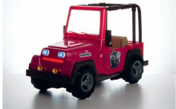
Рис. 1.24. Масштабная модель автомобиля с фарами, управляемыми Arduino
