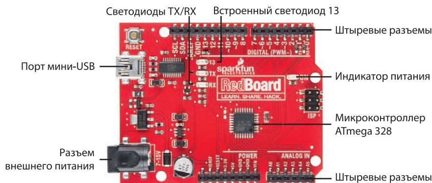
Рис. 1.3. Плата RedBoard компании SparkFun, совместимая с платой Arduino Uno. Обратите внимание, что форма платы совпадает с формой платы Arduino Uno, показанной на рис. 1.2
